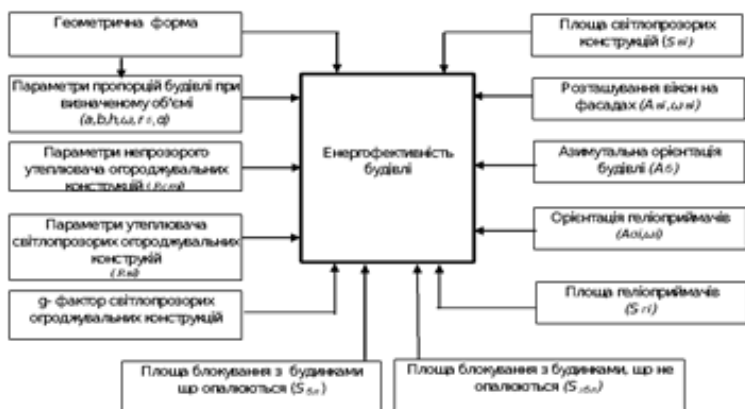
Рис.1. Параметри, що впливають на енергоефективність будівлі заданого об'єму
